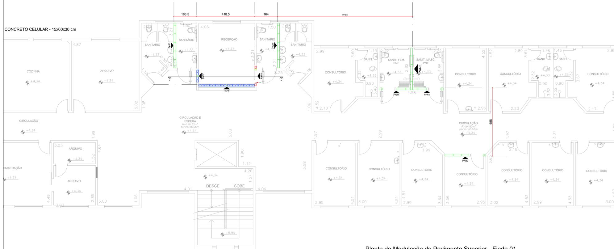
Planta de Modulação do Pavimento Superior - Fiada 01
